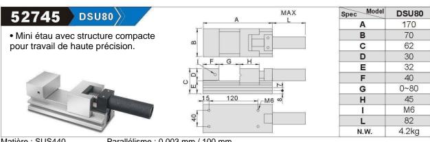
Matière : SUS440 Parallélisme : 0,003 mm / 100 mm Dureté : HRC 48° ~ 55° Perpendicularité : 0,003 mm / 100 mm
