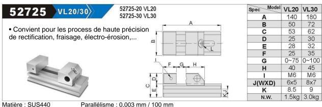
Dureté : HRC 48° ~ 55° Perpendicularité : 0,003 mm / 100 mm
