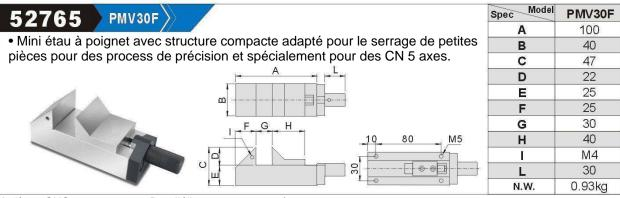
Matière : SUS440 Parallélisme : 0,003 mm / 100 mm Dureté : HRC 48° ~ 55° Perpendicularité : 0,003 mm / 100 mm
