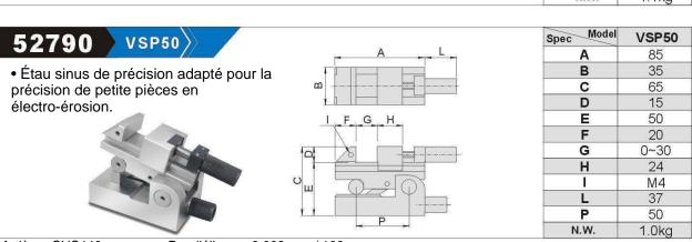
Matière: SUS440 Parallélisme: 0,003 mm / 100 mm Dureté: HRC 48° ~ 55° Perpendicularité: 0,003 mm / 100 mm
